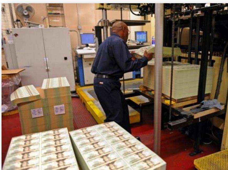
На следующем этапе полученные листы проверяют вручную на наличие дефектов. Листы с дефектами уничтожаются. Затем купюры отправляются на компьютерное сканирование, где осуществляется дополнительная выбраковка.
